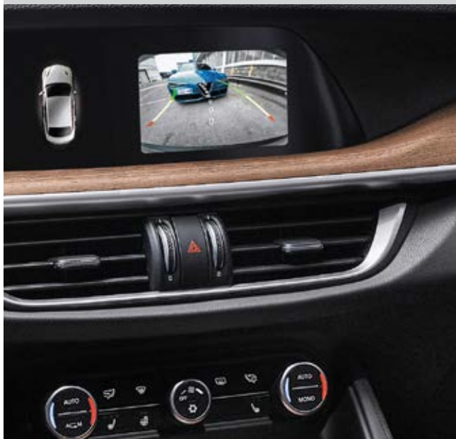
TELECAMERA POSTERIORE CON LINEE GUIDA DINAMICHE
